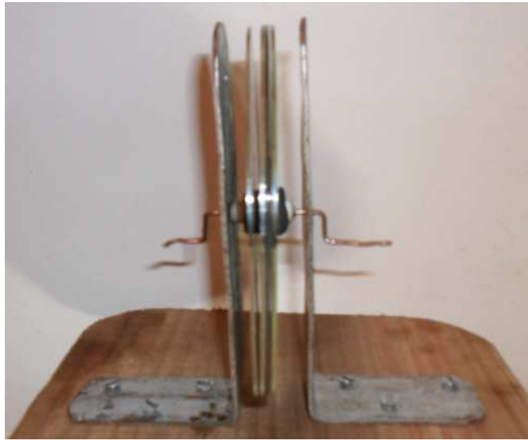
Figura 16: Montagem do volante e virabrequim.
