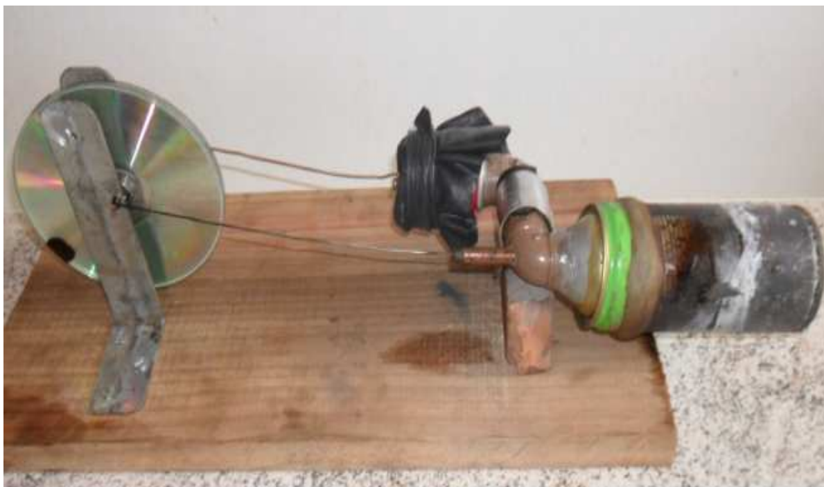
Figura 18: Maquete de motor Stirling pronta para testes.
