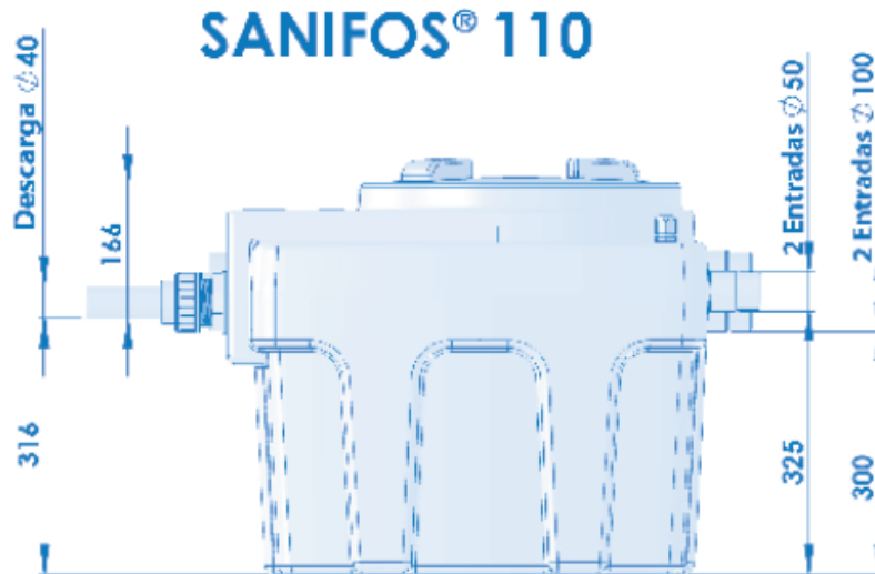
Figura 16: Vista Lateral da Estação Elevatória Sanifos 110
