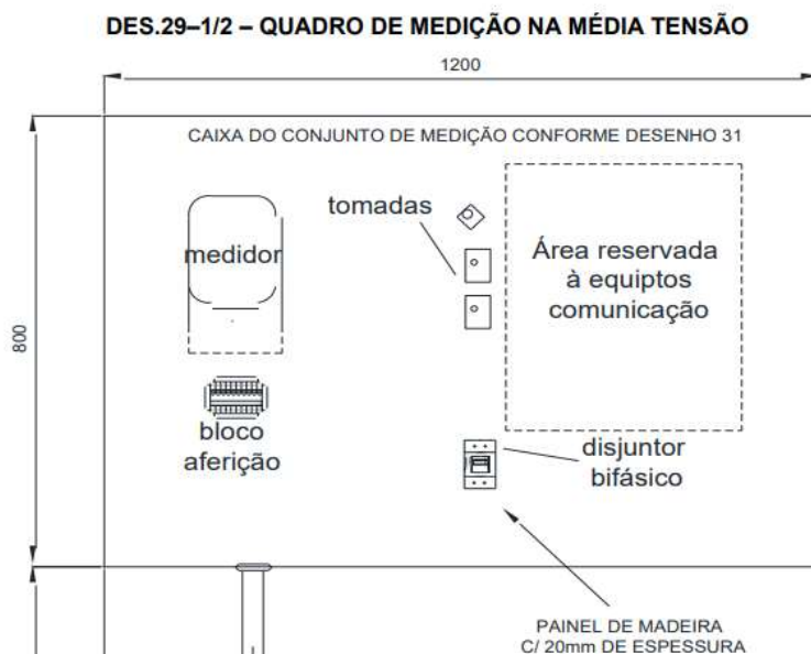
Figura 11: Desenho da norma do padrão de medição instalado
