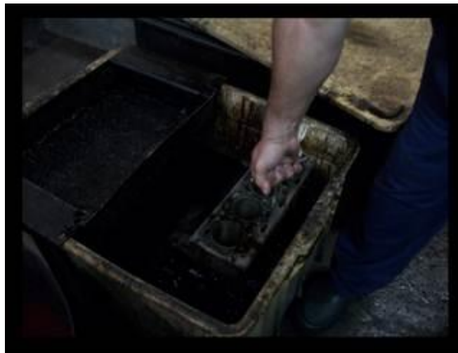
Figura 4: Motor mergulhado em produto químico
